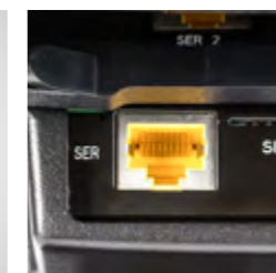
Connessione diretta, senza alimentazione, all'antenna Orderman (PoE) (opzionale)
